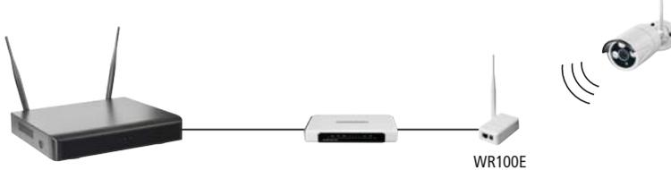
Einsatz eines WR100E (optional erhältlich) als WLAN\*\* -Repeater:
